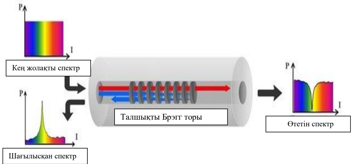
1.2-сурет – Талшықты Брэгг торының жұмыс жасау принципі
